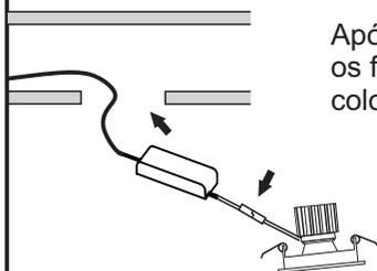
Após ligar o driver conecte os fios da luminária e coloque-o dentro do forro.
